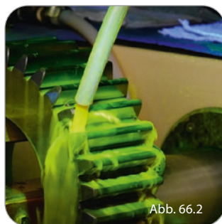
Magnetpulver-Rissprüfung / magnetic particle crack testing
